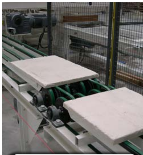
Transfert automatique des produits et des moules Automatic product and mold conveying system
